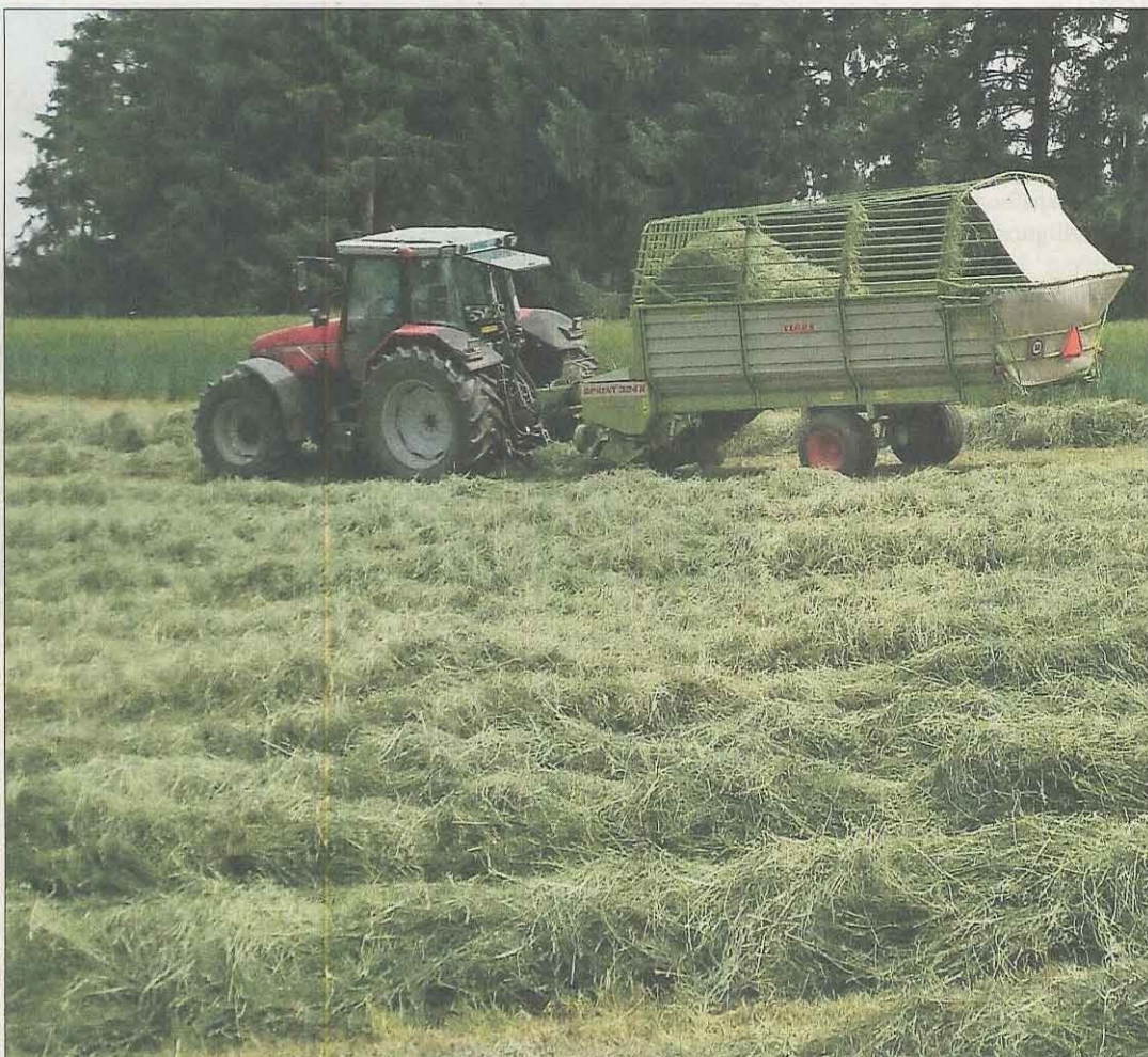
Vielerorts kommt immer noch der Ladewagen zum Einsatz. Vor allem bei kurzen Hof-Feld-Entfernung erzielt man mit ihm eine hohe Schlagkraft. (Bild BauZ)
