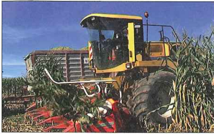
Die Silierkette ist auf die Leistung des Häckslers abzustimmen
