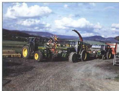
Silierkette mit Scheibenmäher, Feldhäcksler und Dosierwagen
