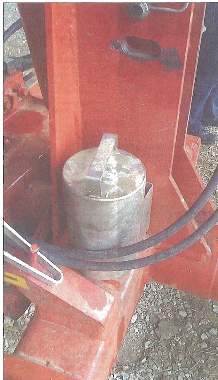
An jede Maschine der «Cuma de la montagne» ist für das Begleitdokument eine Metallhülse angeschweisst. (Bild Agridea)
